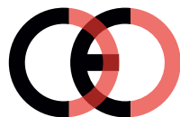
Falsk CE-mærke (for tæt på hinanden)
